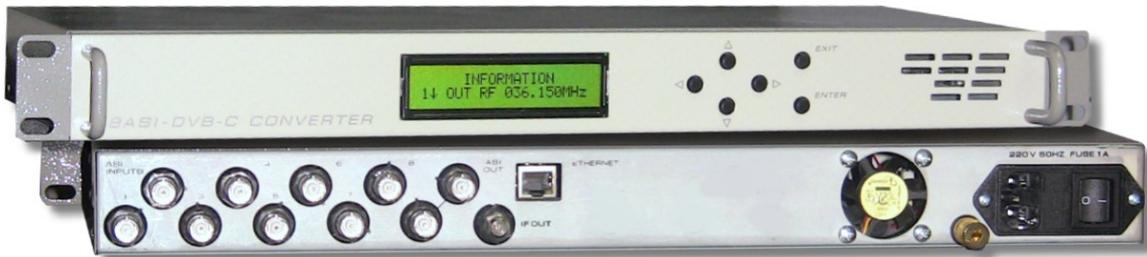
Конвертер позволяет сформировать из 8 цифровых потоков ASI, требуемый пакет цифровых программ и выдать этот пакет на поднесущей в соответствии со стандартом DVB –C. Сигнал с выхода конвертера подается на вход ПЧ канального модулятора головной станции кабельного телевидения. IP выход может использоваться для мониторинга потоков со входа и с выхода конвертера, а также для трансляции потока в локальную сеть.
