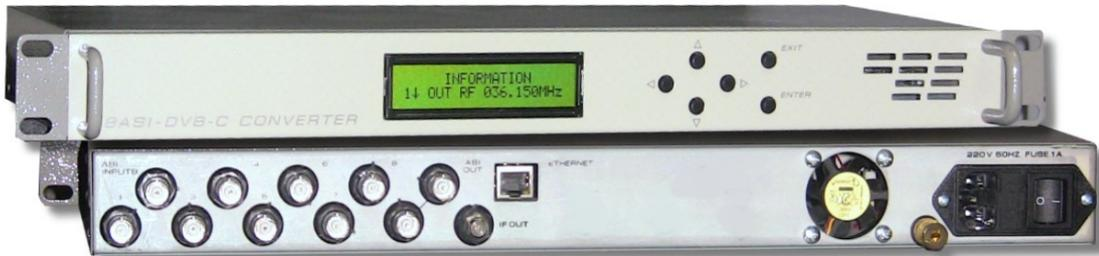
Выходной сигнал снимается с разъема типа F и подается на вход промежуточной частоты канального модулятора.
