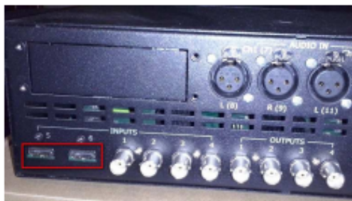
Фото 1. Задняя панель корзины микшера DSC924/928
