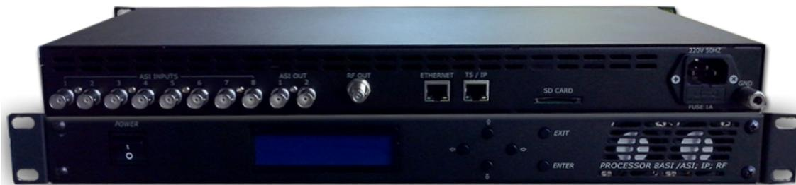
Работа с Процессором начинается с его подключения к контуру заземления и к питающей сети 220В, 50 Гц– соответствующие разъем и клемма на задней панели.
