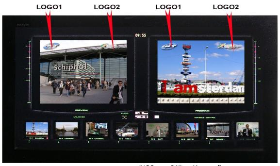
картинок в памяти микшера размером "128 x 96"). Каждый из логотипов можно располагать на экране в произвольном месте. Кроме этого, цифровые часы имеют отдельную настройку местоположения на экране. Включение и выключение логотипов производится с плавным микшированием.
