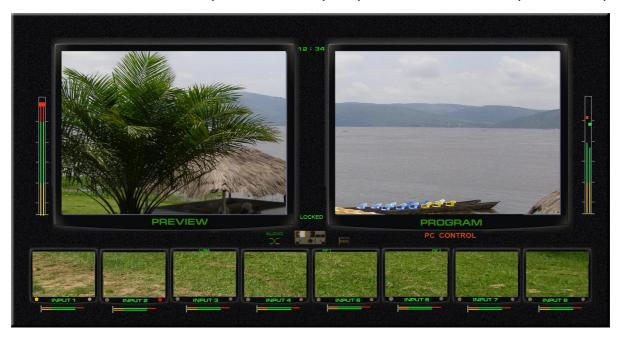
Экран мультискрина позволяет одним взглядом оценить текущее состояние микшера — какие сигналы включены на preset, программу, какие дополнительные сигналы наложены на выходной сигнал, какой сигнал готов к выдаче в эфир, информация об уровнях звукового сопровождения. Кроме того выводится вспомогательная информация - текущий спецэффект, ведение от сигнала внешней синхронизации и т.д.
