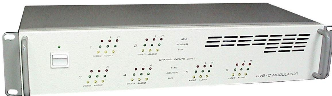
На передней панели прибора имеются 6 групп светодиодных индикаторов ( по числу каналов).
