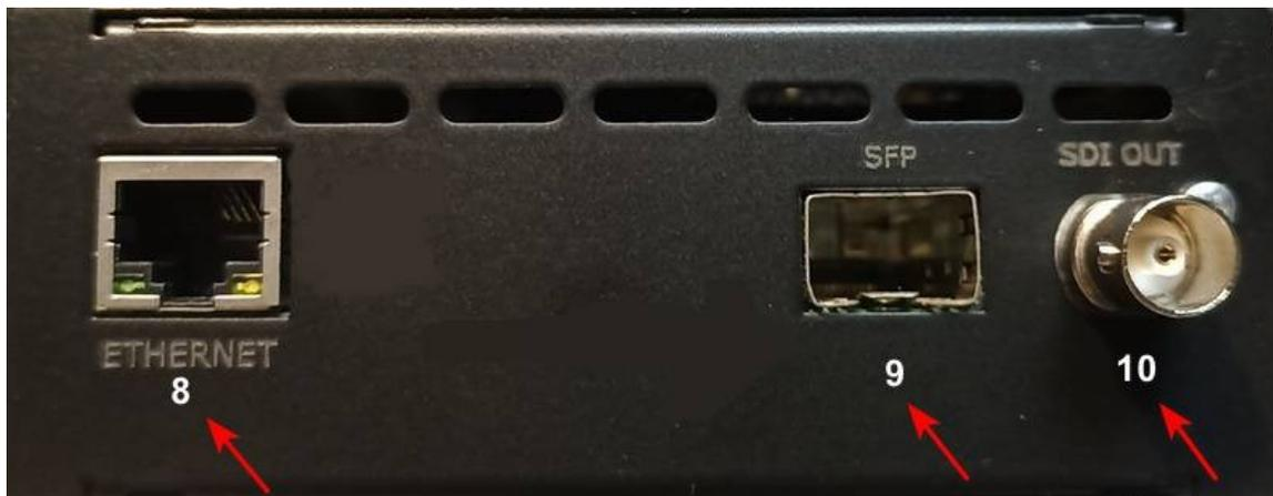
Обновление программного обеспечения камерного блока производится в случае необходимости через разъем RG45 (разъем 8) интерфейса Ethernet. На корпусе камерного блока имеется
