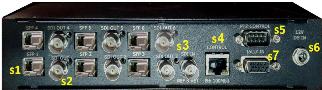
Оптические кабели от камерных блоков подключаются через модули SFP+ (Ethernet\_10G) к студийному блоку (гнездо s1 для первого канала), где видеосигналы проходят коррекцию в кадровых синхронизаторах и выдаются на выходные разъемы SDI (разъем s2 для первого канала) в форматах "1080p50Hz" или "1080i50Hz" (в последнем случае в студийном блоке производится конверсия до формата "1080i50Hz").
