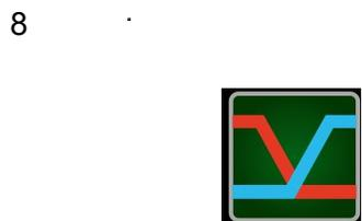
«V»-переключение осуществляется с плавным полным выведением одного сигнала с последующим плавным вводом другого. До середины перехода звуковое сопровождение текущего канала плавно уходит в 0, а во второй половине перехода постепенно нарастает звуковое сопровождение нового канала
