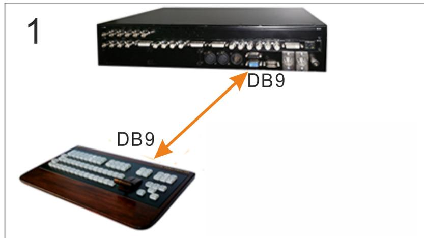
2. Если нужно увеличить расстояние между пультом и базовым блоком, его можно подключить по локальной сети Ethernet. В этом случае нужно дополнительно подать питание +12 V).
