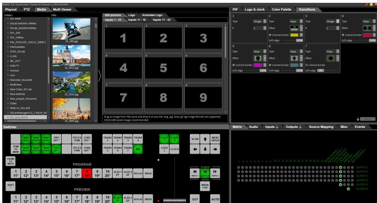
RING-22 Switcher Control также обеспечивает настройки микшера по входам и выходам, расстановку логотипов, часов, окон PiP на программном выходе.
