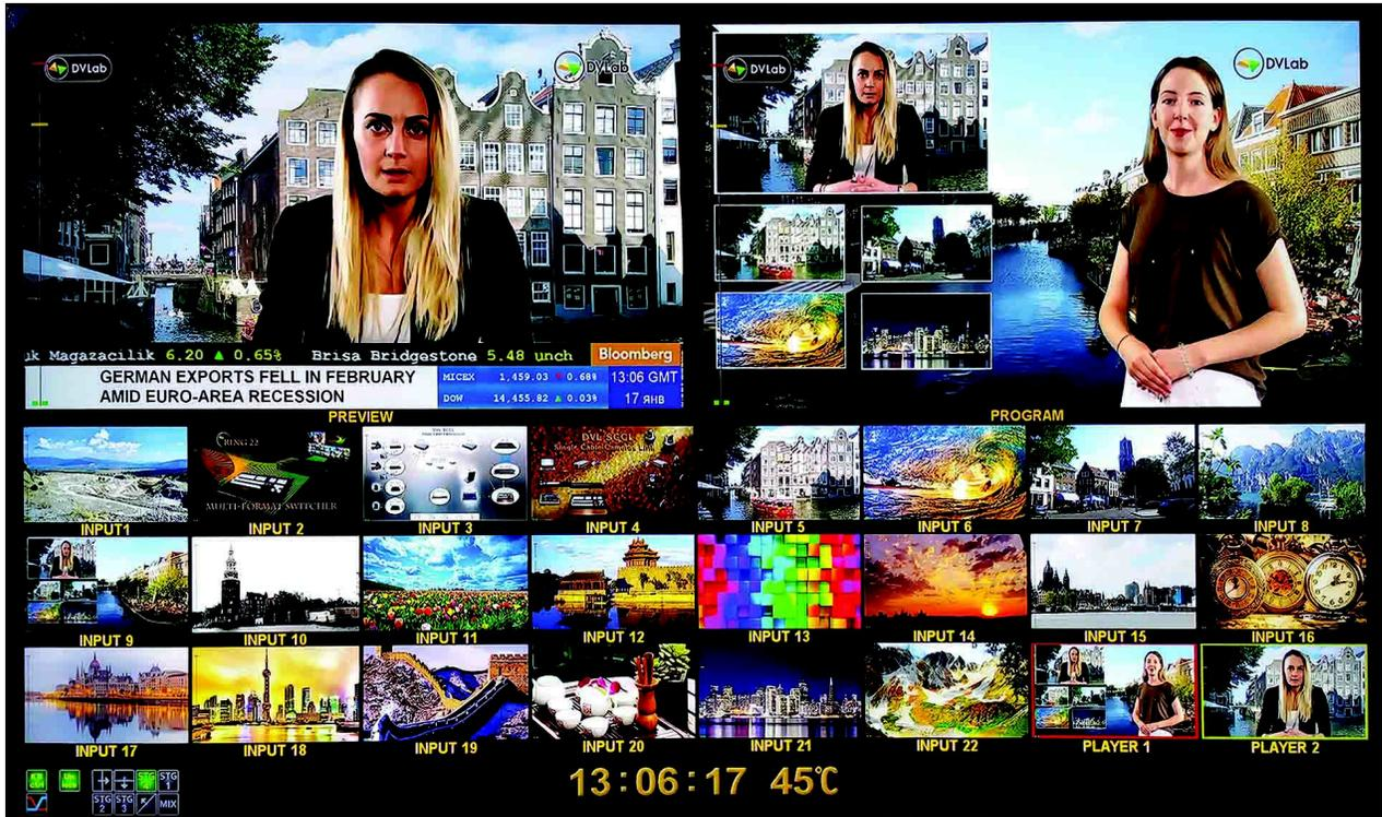
Сигнал Мультиэкрана можно направить на любой из выходов видео микшера. Соответственно для отображения Мультиэкрана можно использовать монитор или телевизор, имеющий вход DVI-D или SDI, поддерживающий разрешение 4K или 1920X1080i пикселей при 50Гц.
