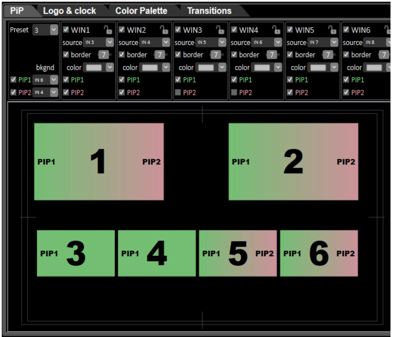
Закладка настройки пресетов PiP в программе «RING 22 SwitcherControlPanel».
