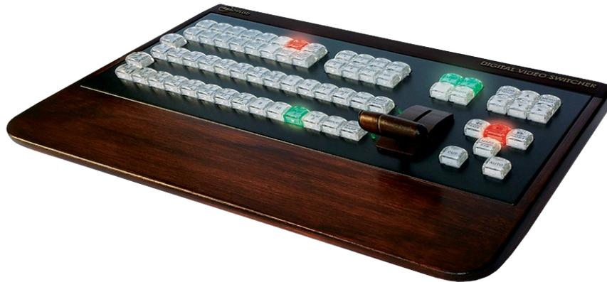
Базовый вариант позволяет управлять всеми вариантами микшеров, но для микшера Maxi доступ к каналам с 11-по 22 возможен через кнопку SHIFT.
