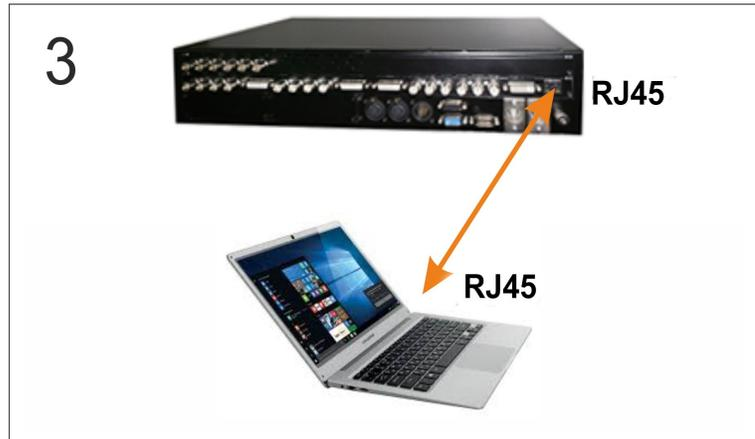
4. Управление микшером от пульта и компьютера (RING22 Switcher Control) одновременно. Пульт дистанционного управления подключается к базовому блоку одним кабелем с разъемами DB9F, а компьютер - по локальной сети Ethernet.
