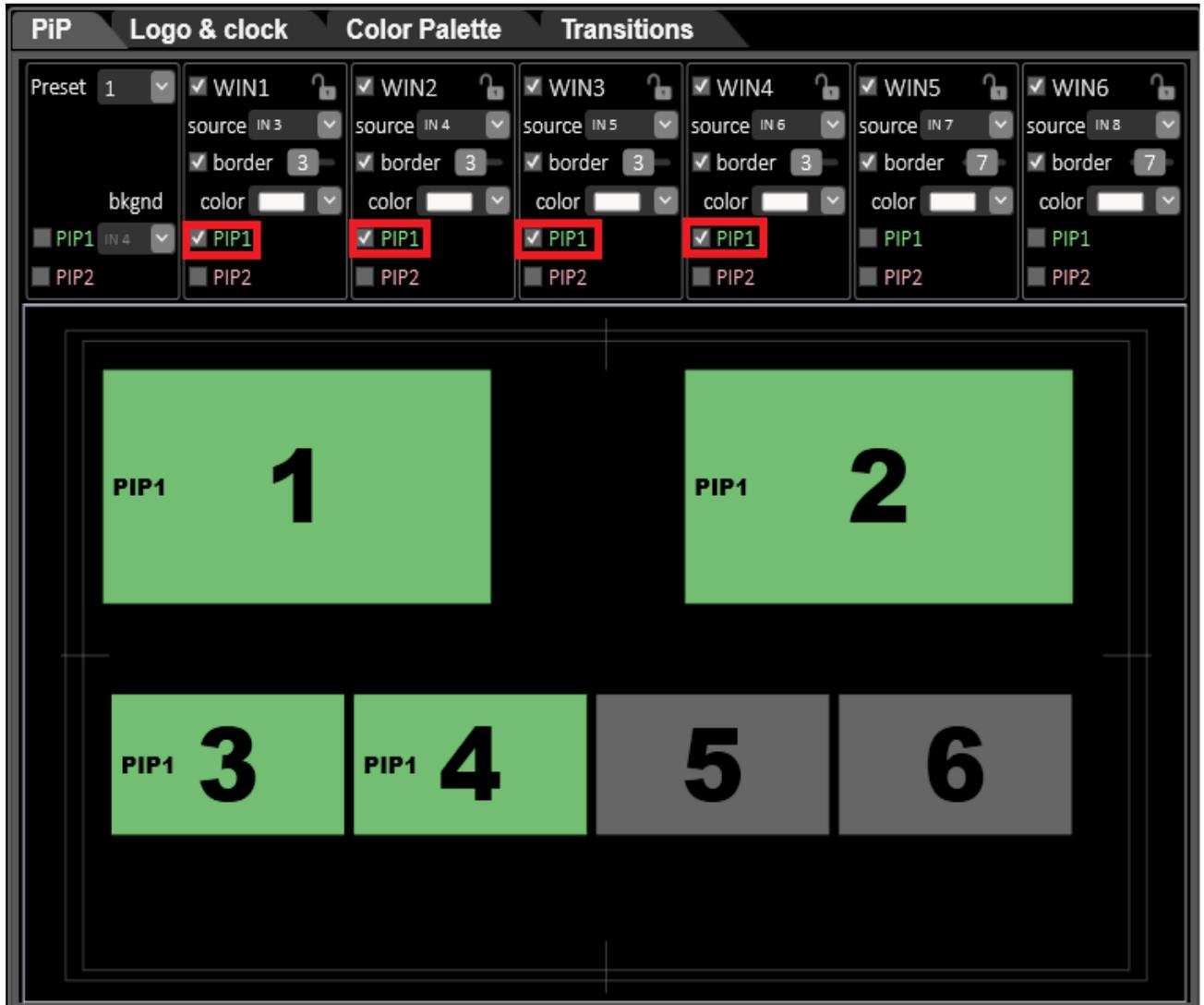
При этом активированные окна отобразятся зеленым цветом в превью закладки PIP в программе «RING-22 Switcher Control Panel».
